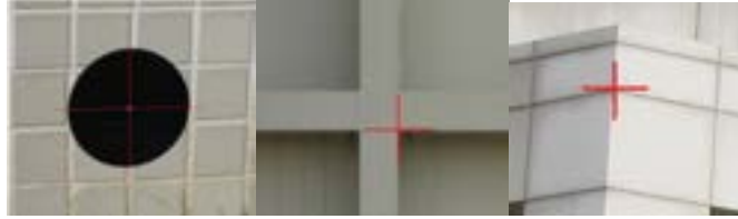
圖 23、物徵控制點、牆面控制點量測準則（十字紅標表示觀測者應瞄準之瞄準線）
