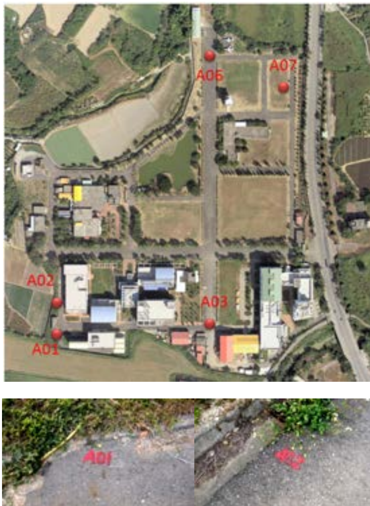
圖 20、GPS 控制點位置示意(上),GPS 控制點現場標記(下)
