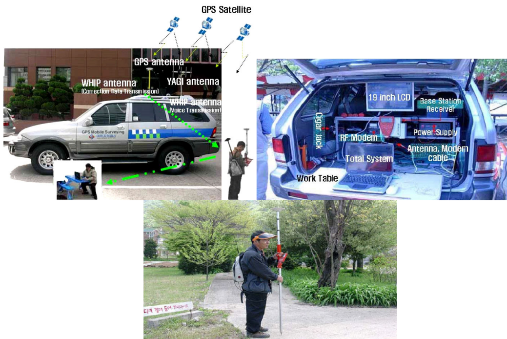
圖 1. Kim et al. (2006) 使用的地籍測量車系統之組成和其外觀(上)、移動站點位測量(下)
