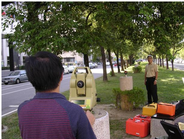
圖 5 電子測距基線場
