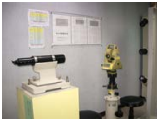
圖20 經緯儀校正系統
