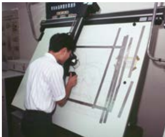
圖7 以坐標讀取儀辦理數值化作業
