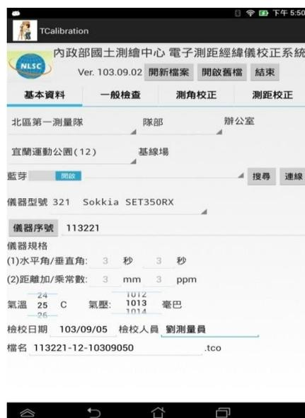
圖 3：行動版電子測距經緯儀校正系統主畫面(行動版)
